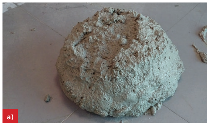
2. a) Beton referencyjny b) Beton ze zredukowaną zawartością frakcji drobnej.
