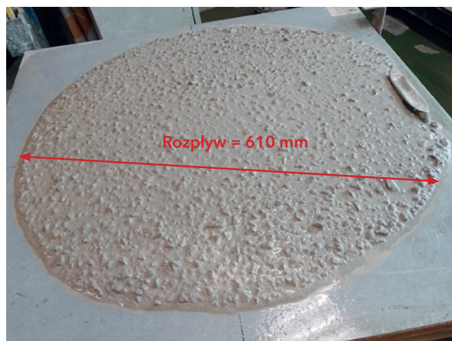
5. Beton ze zredukowaną zawartością frakcji drobnej bez MasterMatrix LF.
